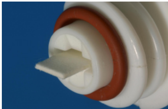
Abb. 20: In das Kopfende des Prüfkörpers inserierter Bioindikator
