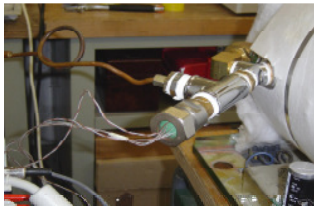
Abb. 15: Angebrachter Validierungsstutzen an dem Sterilisator VALIDATOR PLUS
