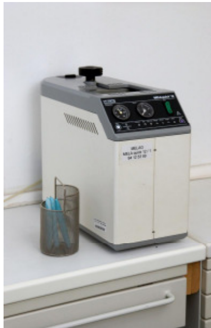
Abb. 11: Neben dem Sterilisator MELAquick befindet sich der mit Prüfkörpern beladene Instrumentenkorb
