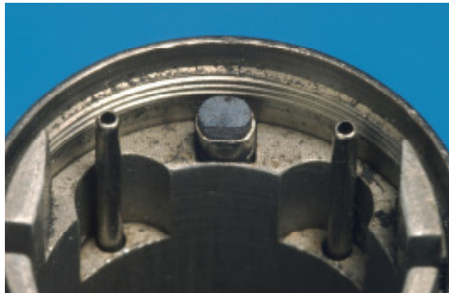
Abb. 2: Übertragungsinstrumentenunterseite mit Spraykanaleingängen
