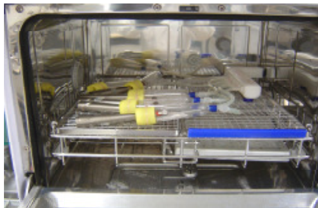
Abb. 13: Der Desinfektionsautomat PICO Flush ist mit an die Schnellverbinder angeschlossenen Winkelstücken beladen
