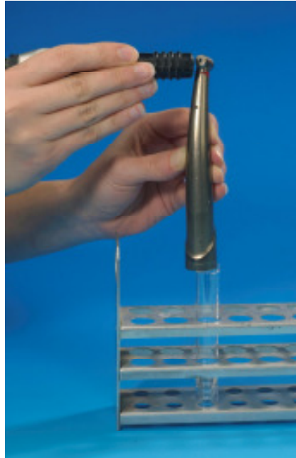
Abb. 7: Das Restwasser in den Kanälen wurde vor der Auspipettierung mit Hilfe von Druckluft in ein Reagenzröhrchen gebracht
