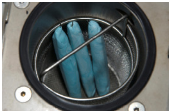
Abb. 12: Der Instrumentenkorb wurde mit senkrecht stehenden Prüfkörpern in die Sterilisatorkammer eingesetzt
