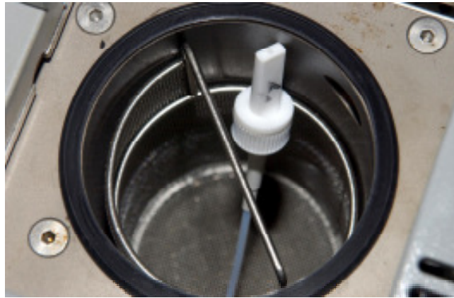
Abb. 21: Der Helix-Prüfkörper wurde stehend in den Instrumentenkorb des MELAquick eingebracht
